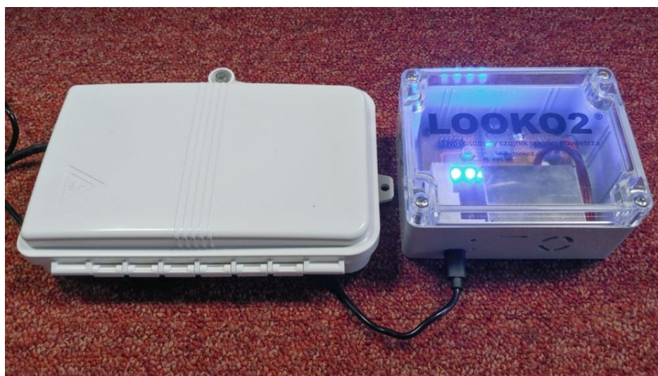
Rys. 2. Widok ogólny czujnika pyłu zawieszonego z modułem GSM (po lewej).
