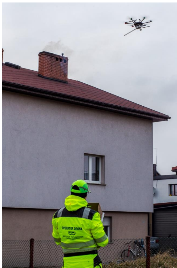
Rys. 1. Pomiar stężeń PM10 i CO 2 nad emitorem w jednym z hot-spotów.
