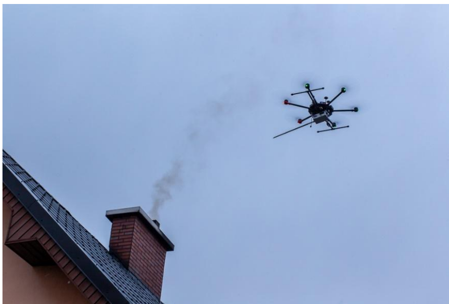
Rys. 6. Dron podczas pomiaru nad dymiącym emitorem.
