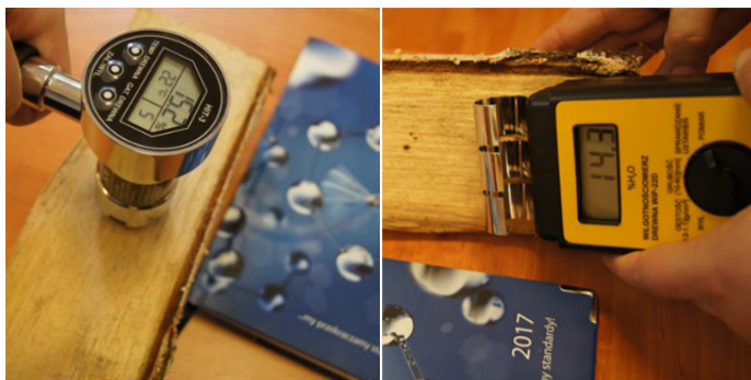
Rys. 10. Sposób wbicia elektrod wilgotnościomierza w kawałek drewna opałowego
