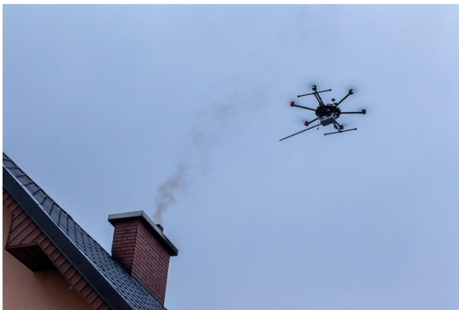
Rys. 6. Dron podczas pomiaru nad dymiącym emitorem.
