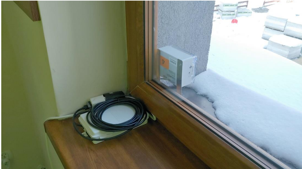
Rys. 3. Zainstalowany czujnik pyłu zawieszonego - widok od środka pomieszczenia.
